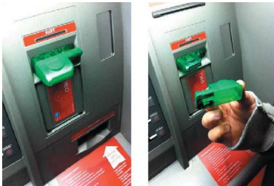
Zdjęcia ilustrują czytnik do sczytywania danych z paska magnetycznego karty bankomatowej
